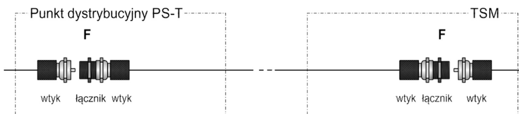
Rys. 9.6. Podłączenie kabli koncentrycznych [125]
